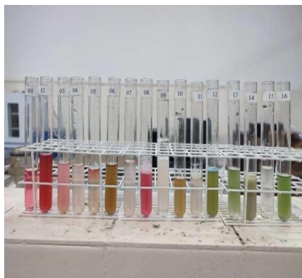
Figura 51 - Paleta de cores utilizando os reagentes do cotidiano com indicador extraído da mistura de água-etanol 50:50 (v/v)
