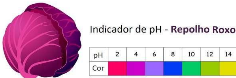
Figura 48- Indicador ácido-base a partir do repolho roxo
